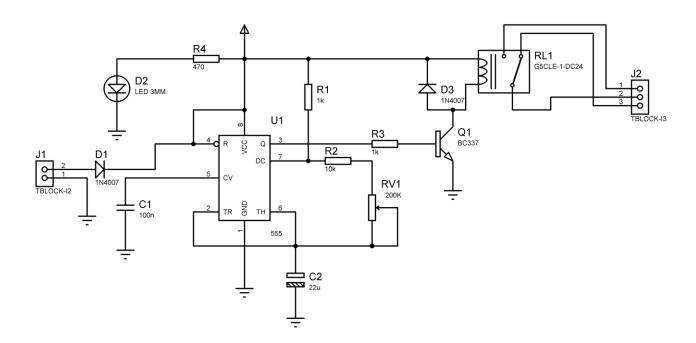
O primeiro passo para se fazer um roteamento utilizando software é desenhar o diagrama esquemático, pois a partir dele será feito o roteamento da placa, automático ou não. Outro detalhe muito importante que deverá ser observado são as dimensões dos componentes do projeto, bem como as medidas da caixa onde o projeto será colocado.
